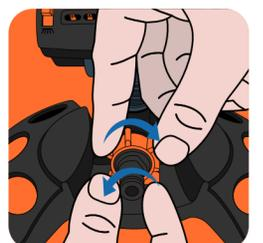
Anschließend kannst du das Sieb mit den Fingern oder einem Schraubendreher herausnehmen. Das Sieb unter fließendem Wasser gründlich ausspülen und wieder einsetzen.
